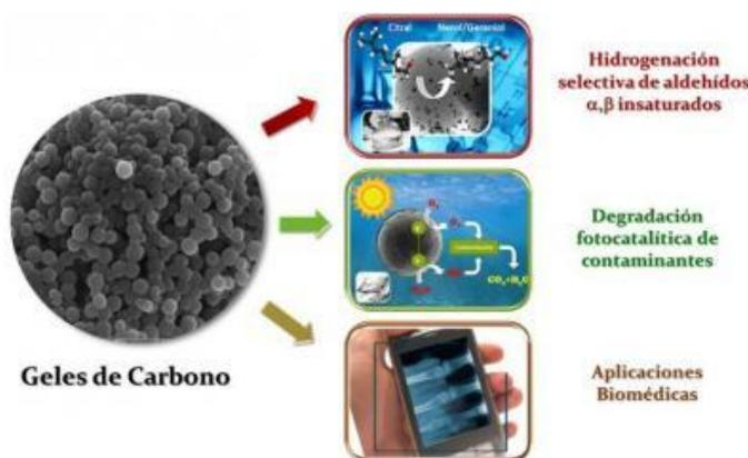
Geles de carbono con morfología, textura porosa y química superficial diseñada, controlada y ajustada a escala nanométrica para su aplicación en catálisis, fotocatalisis y biomedicina.
